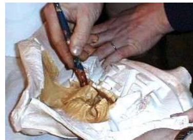
Appliquer de l'Acrystal Decor Metal sur le moule afin d'éviter les bulles de surface
